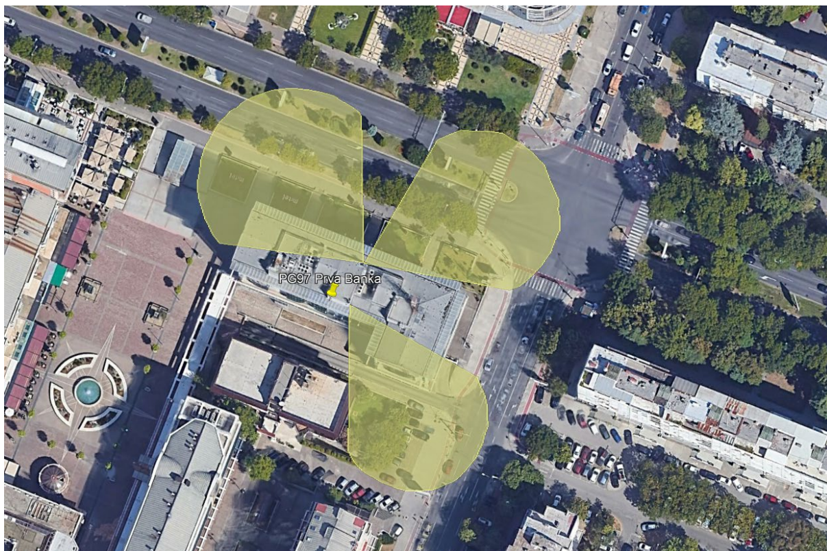
Slika 4. Pozicija antenskih nosača sa prikazanim azimutima Mtel antena, sa graničnom zonom i okolnim objektima
