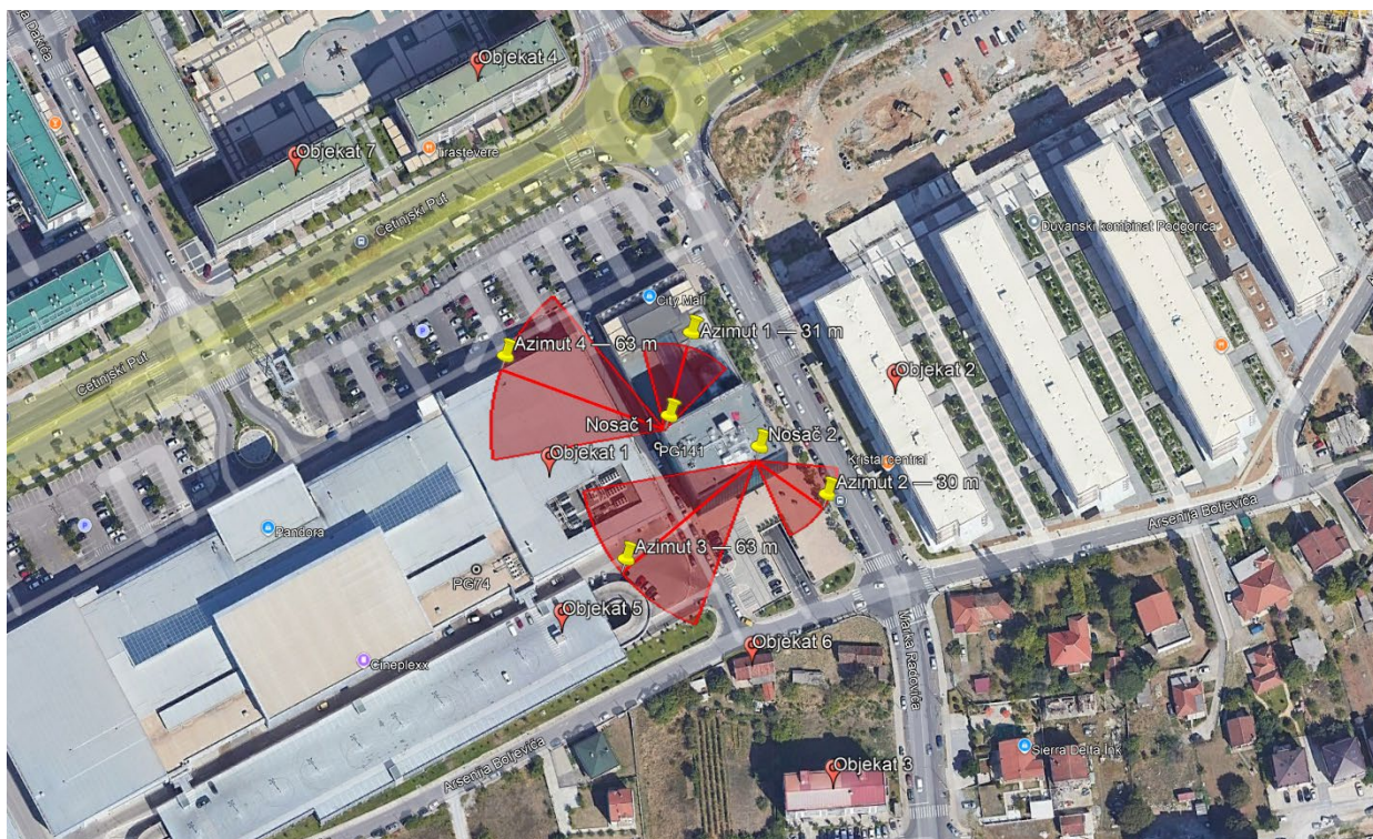
Slika 4. Pozicija antenskih nosača sa prikazanim azimutima Mtel antena, sa graničnom zonom i okolnim objektima
