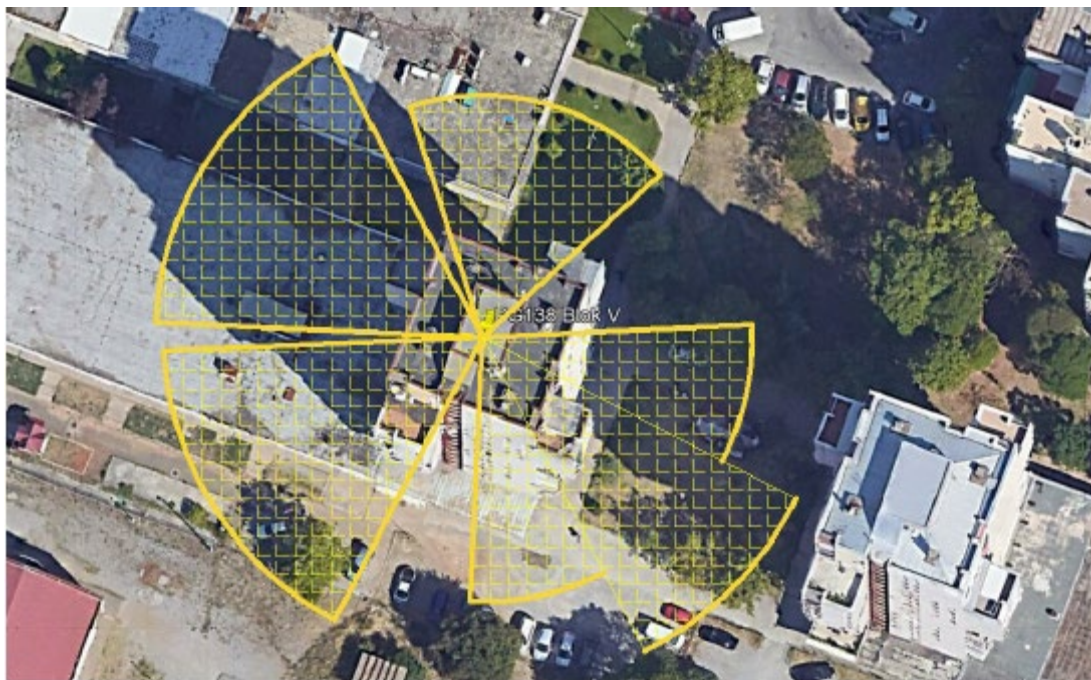
Slika 7.4. Pozicija antena sa ucrtanim pravcima i graničnim zonama
