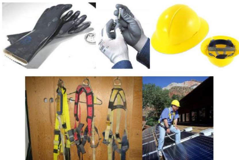
Slika 56. Zaštitna oprema koju treba nositi prilikom instalacije opreme
