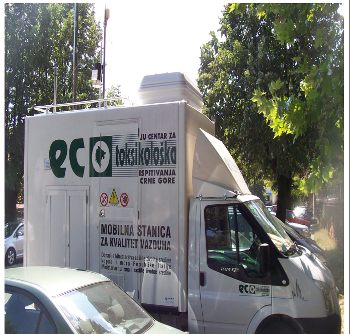
Slika 7. Mobilna stanica sa mjernom opremom za kontrolu kvaliteta vazduha
