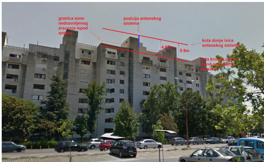
Slika 5. Zona nedozvoljenog zračenja u vertikalnoj ravni
