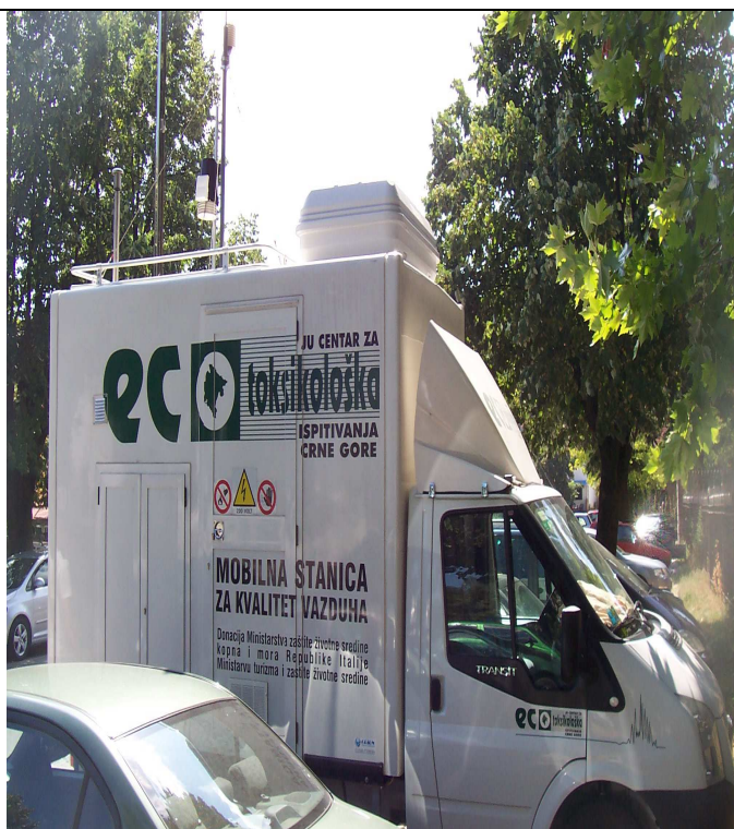
Slika 7. Mobilna stanica sa mjernom opremom za kontrolu kvaliteta vazduha
